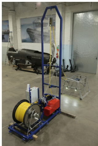
Рис 3. Видеокомплекс для визуального учета макрозообентоса производства ООО «Фертоинг»
